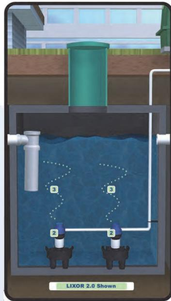
Chaque système LIXOR s'installe facilement dans des bassins nouveaux ou existants et est équipé d'un aérateur régénératif situé à terre, la seule pièce mobile du système, simplifiant et réduisant considérablement les coûts de maintenance. Les LIXOR ajoutent une nouvelle dimension de flexibilité et de performance dans la conception et les mises à niveau des systèmes d'eaux usées.
